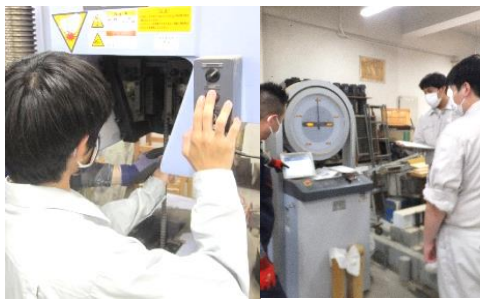
鉄筋引張試験
