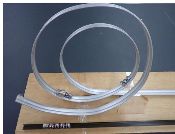
転がした鉄球が、衝突の直前にネオジム磁石の磁力によりエネルギーを得て加速された後に衝突し、反対側の鉄球などに多くのエネルギーを与えて発射する加速装置。
