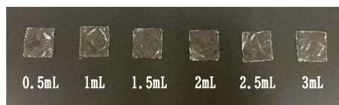
図2 0.5~3mL のホルマリンを添加し、作製した寒天プラスチック
