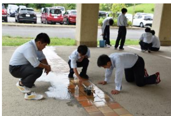
【物理講座】濡れたタイルの滑りやすさを計測する実験
