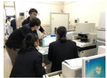
図 4. FTIR(フーリエ変換赤外分光光度計)の操作 関西学院大にて
