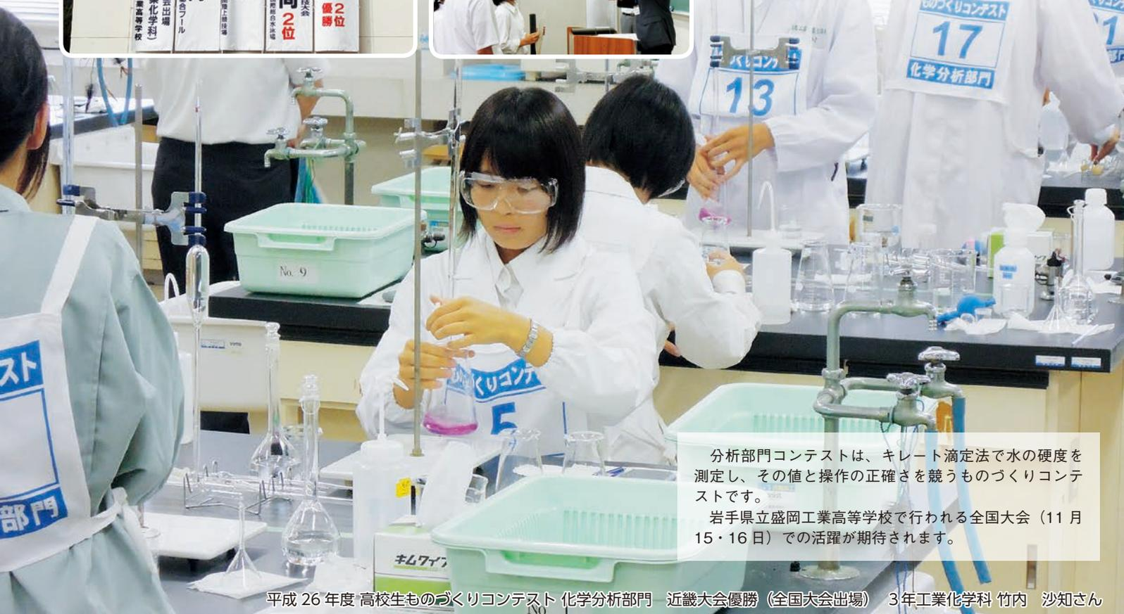
分析部門コンテストは、キレート滴定法で水の硬度を測定し、その値と操作の正確さを競うものづくりコンテストです。
