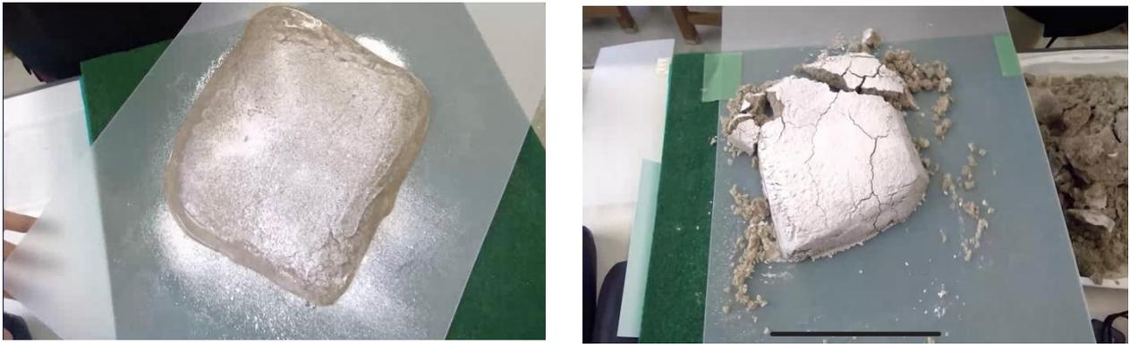
図2 地盤モデルの材質について (予備実験) (左) 失敗(液状化) 砂:水=5:1 (右) 成功 砂:水=5:1
