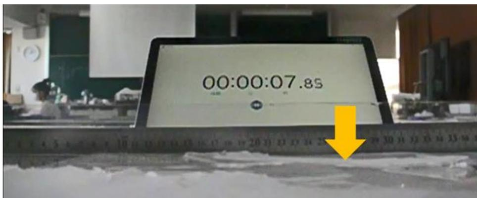
図 4-3 実験結果（側面） 7.85：紀淡海峡通過後 波高は 1 mm程度
