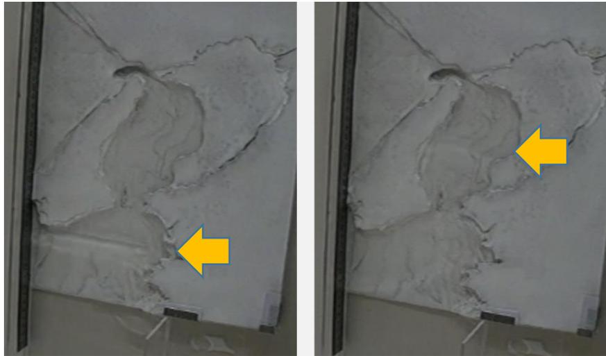
図 5-1 (左) 実験結果 (平面) 7.49 : 波面は直線状ではっきりしている
