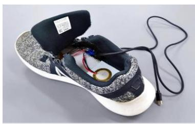
写真9 多段圧電素子を靴の中に設置
