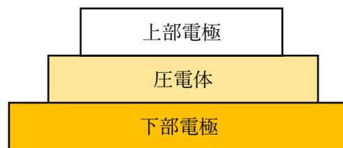
図1 圧電素子の構造
