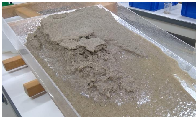
写真4 盛り土崩壊後の地すべりの様子
