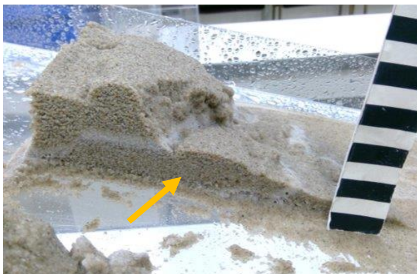
写真2 地すべりモデル実験によるサンドモデルの断面(→の部分に弧状のすべり面が観察できる)
