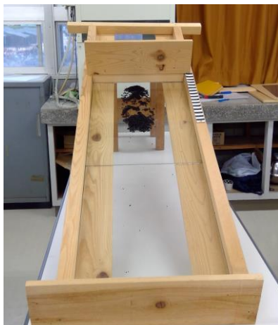
写真 傾斜30度（富士山の火山灰使用）の実験装置
