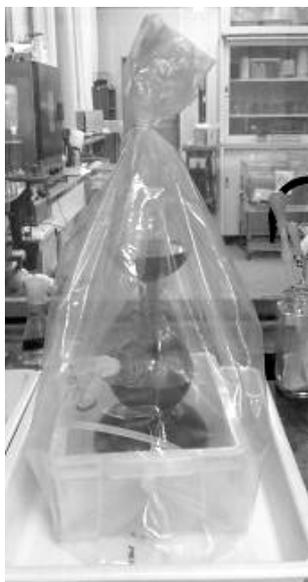
1週間程度断続的にキップの装置を使用する場合、ドラフト内に装置を置き、コックを締めて硫化水素の発生を止めていても、かなり臭気が漏れだしてくる場合があります。数日使用しない時などは、大型厚手のビニール袋にキップの装置ごとに入れてしまうと、臭気漏れがかなり抑えられます(左の写真のビニール袋は厚さ 0.1mm、50×70 cm)。また、硫化水素の特異臭は高濃度では徐々に感じられなくなるので、中毒には注意してください。
