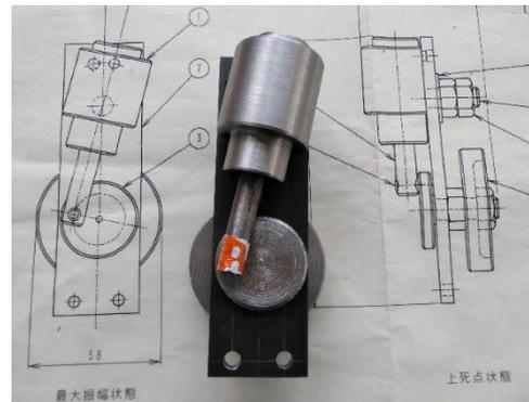
図2 空気発動機（試作型）
