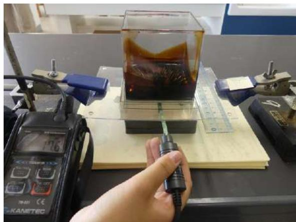
図 3 磁性流体のスパイクの測定実験
