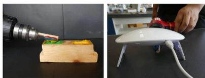
図6 実験操作の写真 (左: レジンに浸す, 右: UVを当てて硬化させる)
