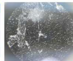
図7 ゴムテープに付着したガムテープ
