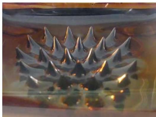
図 1 磁性流体表面に生成するスパイク
