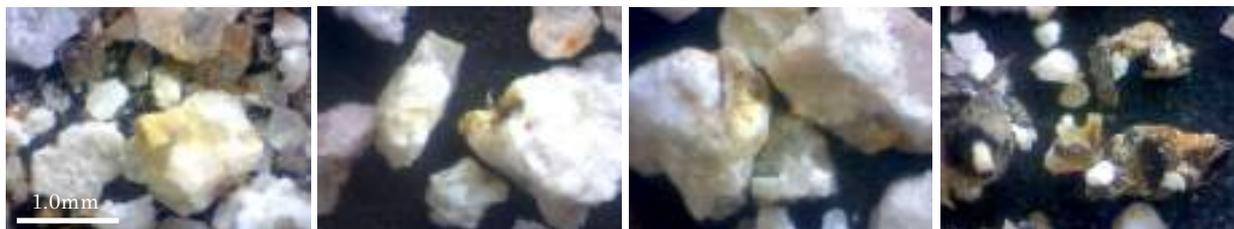
図4 試料 200810-1 (左から、採取した真砂の砂粒、集めた石英、集めた長石、含まれる有色鉱物)
