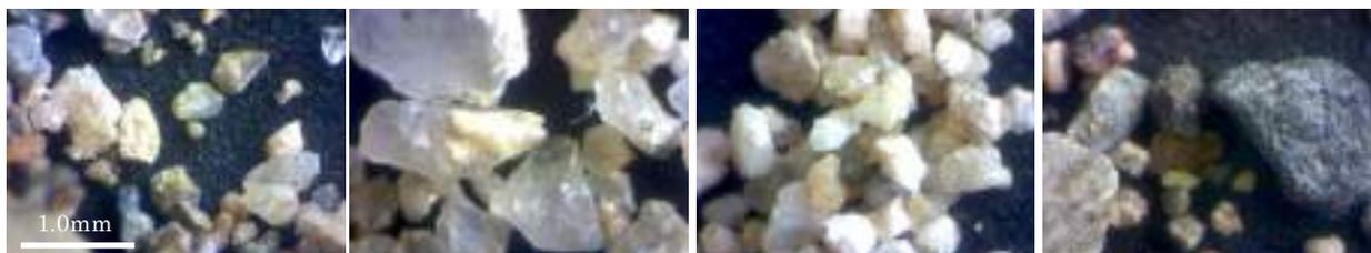
図7 試料 200723-8 (左から、採取した砂粒、集めた石英、集めた長石、含まれる有色鉱物)
