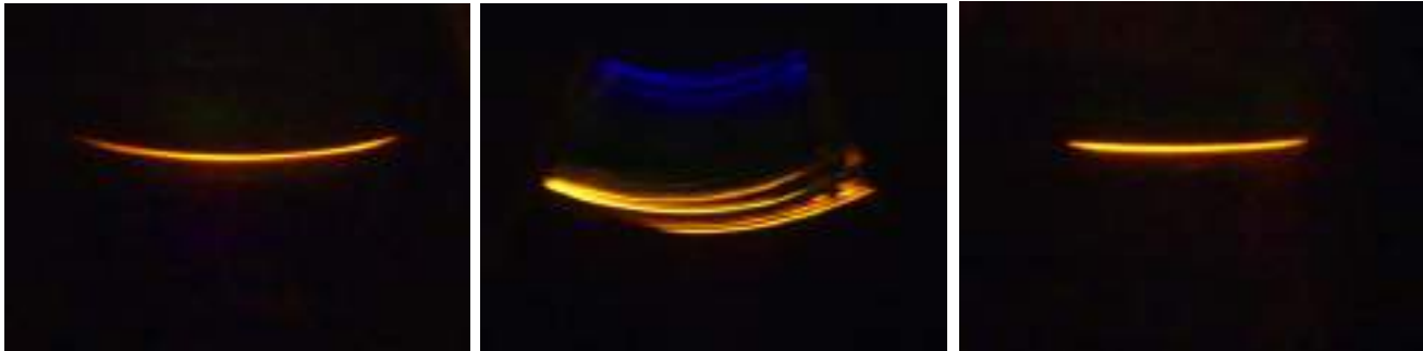
図5 CD-R(左)、単層DVD-R(中央)、単層BR(右)を使った分光実験の結果
