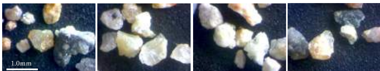
図5 試料 200723-1 (左から、採取した砂粒、集めた石英、集めた長石、含まれる有色鉱物)
