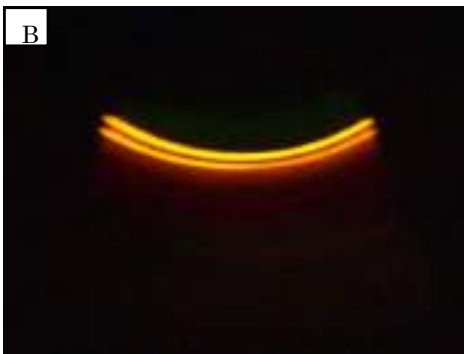
図12 改良型簡易分光器で分光したD線
