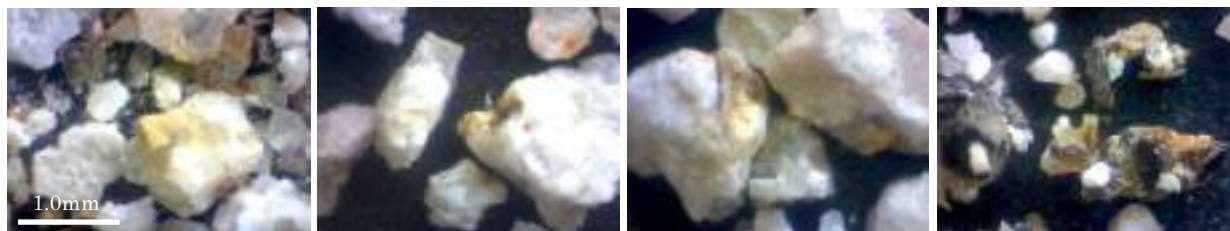
図4 試料 200810-1 (左から、採取した真砂の砂粒、集めた石英、集めた長石、含まれる有色鉱物)
