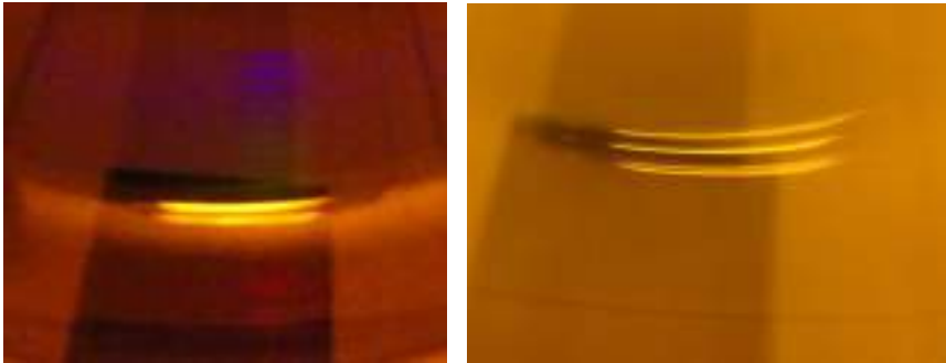
図6 保護面で輝線がぼやけたり(左)余計な輝線が見える(右)
