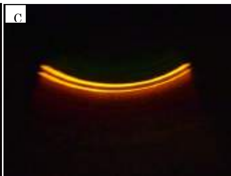
図12 改良型簡易分光器で分光したD線
