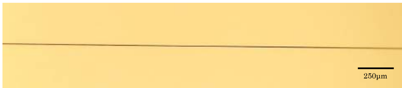
図2 チュウガタシロカネグモの歩行中に発生した直後の糸の顕微鏡写真(40倍)
