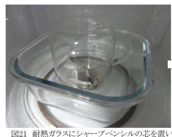
↑図21 耐熱ガラスにシャープペンシルの芯を置いてプラズマを発生させる実験(左)とその結果(右)
