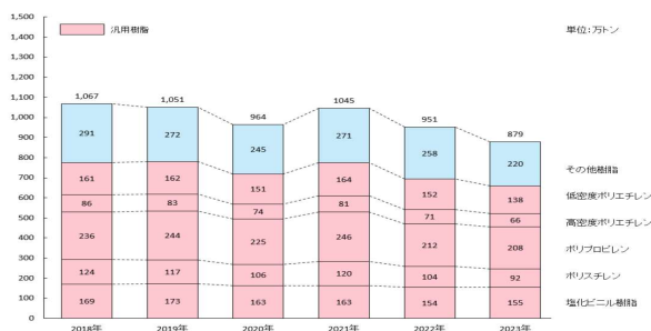
図1) 各合成樹脂の生産量の比較 (EVAは低密度ポリエチレン)
