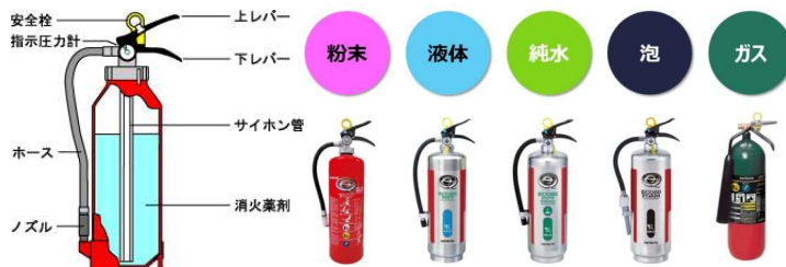
図1 消火器の構造と種類
