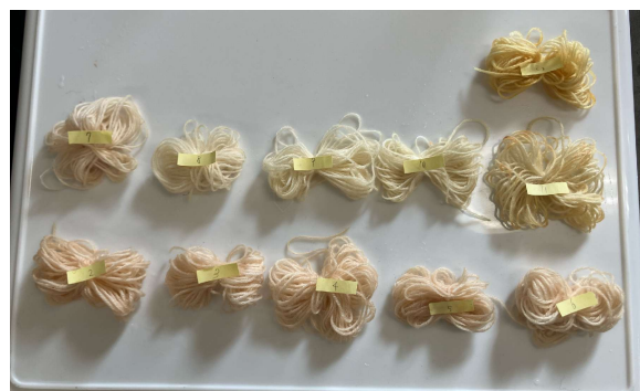
図2 実験の結果(右上のミョウバンを除き、右上から左下に向かってpH11からpH2へと順に並んでいる)
