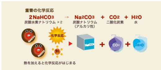
図1 ベーキングパウダーの膨らむ仕組み 1)
