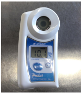
図4 糖度計(ATAGO ポケット糖度計)
