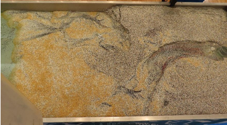
日本地質学会での演示実験のようす (右から左に向かって水流がある。茶色が礫、黒は砂や泥)
