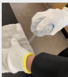
図2 形状記憶合金を冷却する様子
