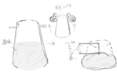
図1:スランプ試験イメージ図
