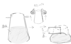
図1:スランプ試験イメージ図
