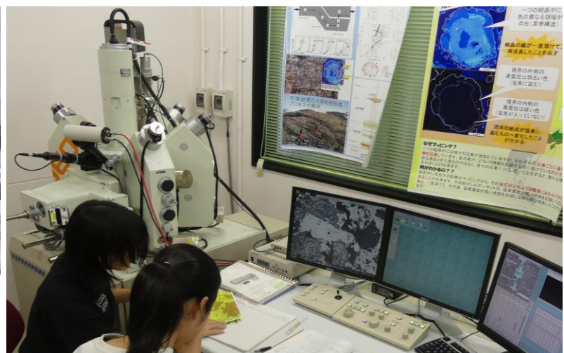
図2 真空炭素蒸着を行った薄片試料(左)とEPMA分析の実施(右/京都大学理学部 JEOL JXA-8105)
