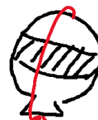
図1: 斜線部分がテープの場所 赤矢印が測定した円周
