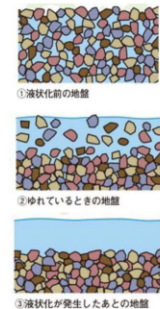
図1:液状化が起こる仕組み 2)
