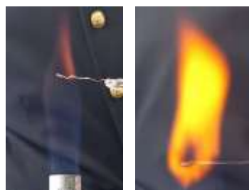
図2 実験②の結果 (左： \text{AlK}(\text{SO}_4)_2 の結晶) (右：混合結晶)
