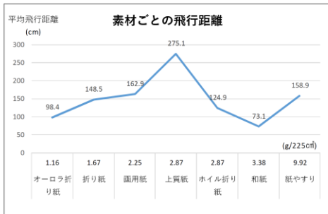
図2 実験Ⅰ 素材ごとの飛行距離
