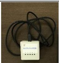
A small white USB switch device with a black cable.                                                                               | なんでもスイッチ USB<br>(スイッチツイストの本体)    | テクノツール       |
