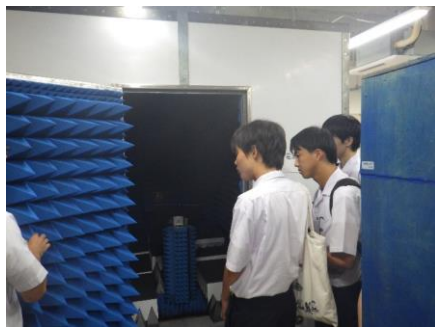
研究室見学① 電気系の研究室では、電波を完全に遮断する暗室に入りました。携帯が圏外になり、驚きました。
