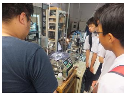
兵庫県立大学理学部訪問 ① 機能性物質学講座では、スピコート法による薄膜電子デバイスの作製方法について教えていただきました。
