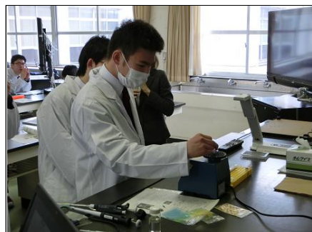
ファイトケミカルの実験① ボルテックスミキサーを使って、試薬を攪拌します。
