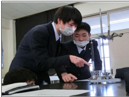
実験操作③～ばねばかりでの測定～ 金属球のみを水中に沈めて、ばねばかりの数値変化を読みとります。
