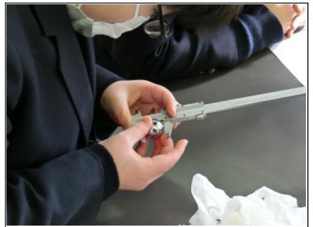
実験操作①～ノギスでの測定～ 金属球の体積を出すために直径をノギスで測定します。初めて使用するので苦労していました。
