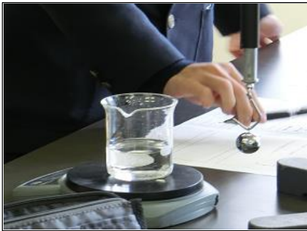
実験操作②～台ばかりでの測定～ 水の入ったビーカーの質量を台ばかりで測定して、金属球を沈める準備をします。
